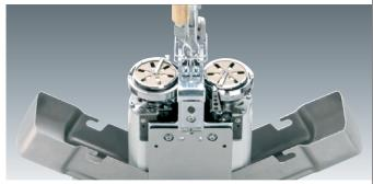
Neue Greifertechnologie mit 3XL-Spule (40 mm Spulendurchmesser) für Nähgarnstärken bis max. Nm 8/3 oder Flechtgarn bis zu eine Stärke bis max. 1,2 mm.
