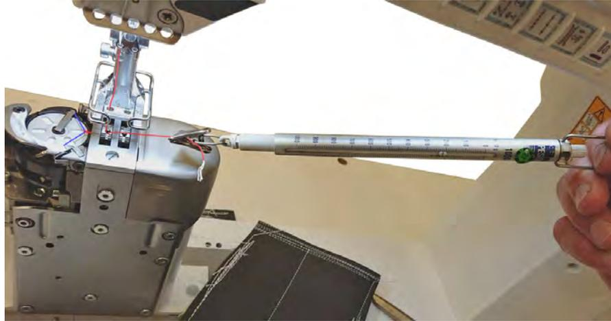
Um die Haltekraft der Greiferfaden-Klemme zu messen, wird der Nadelfaden um den Greiferfaden geschlungen und durch das Stichloch gezogen. Anschließend wird die Kraft mit einer Federwaage gemessen.
