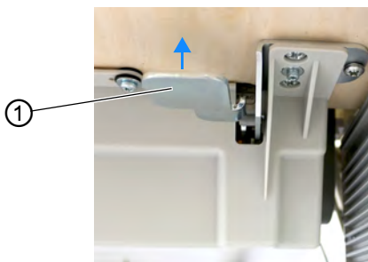
Obr. 84: Zvednutí horní části stroje do svislé polohy
