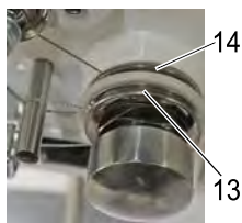
Rys. 13: Nawlekanie nitki igłowej (4)
