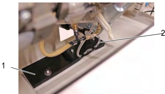
Rys. 80: Montaż przewodu ssącego olej
