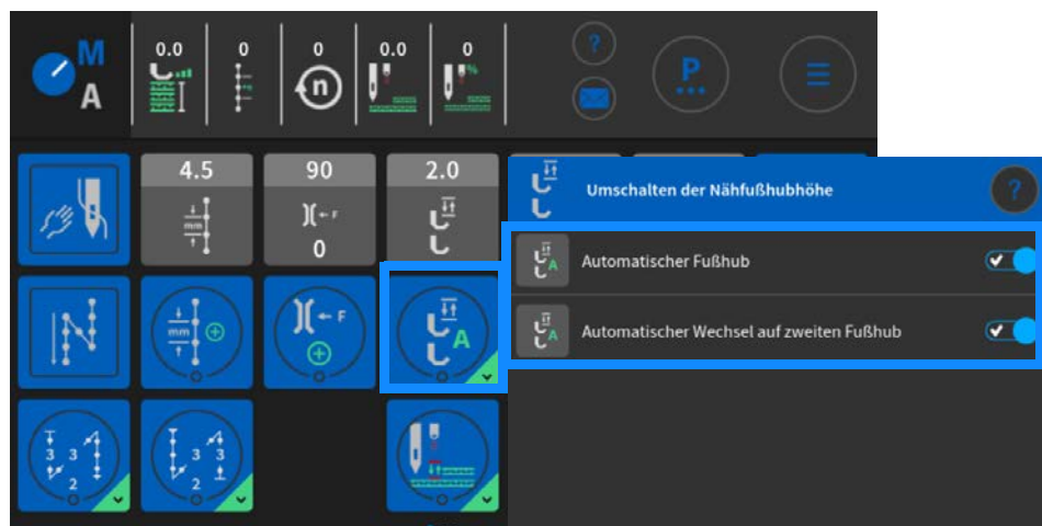
Abb. 9: Automatischer Nähfuß-Hub mit Umschaltung auf 2. Hubhöhe
