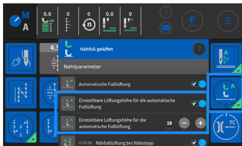
Abb. 11: Automatische Nähfuß-Lüftung mit einstellbarer Lüftungshöhe
