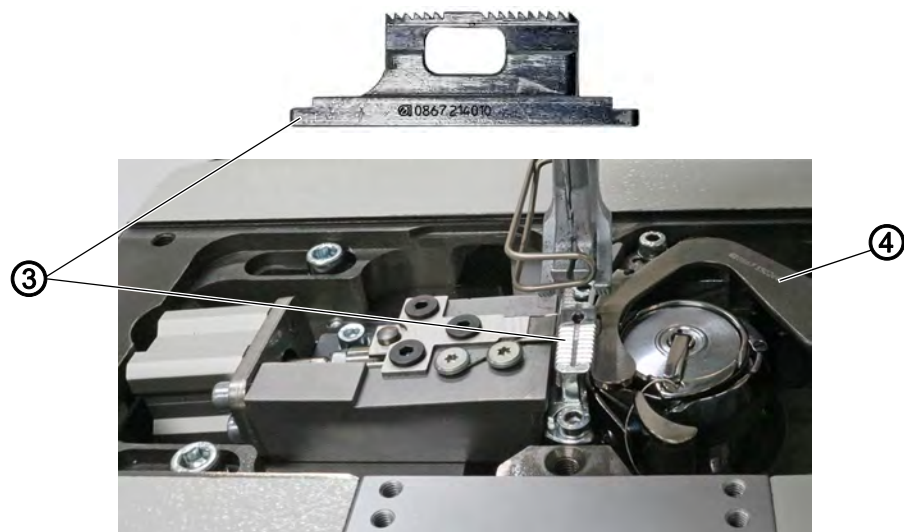
Abb. 8: NSB in die Maschine einbauen (3)
