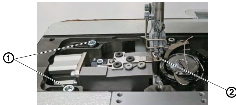
Abb. 7: NSB in die Maschine einbauen (2)
