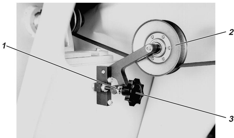
La puleggia di tensionamento 2 per la cinghia trapezoidale determina la lunghezza del punto.
