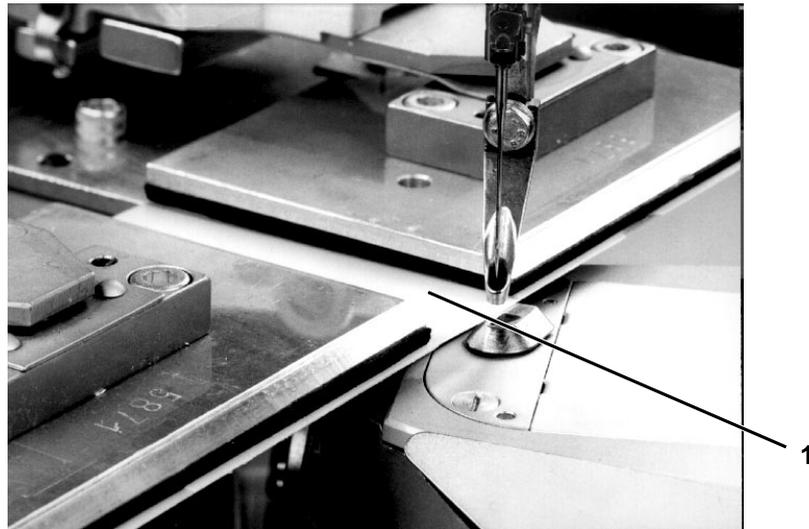
Das Delrin 1 auf der Nähgutaufgabe soll so nah wie möglich an der Nadel stehen, darf diese jedoch nicht berühren bzw. ablenken. Ein beschädigtes Delrin sollte unbedingt erneuert werden, da sonst das Nähgut nicht sicher gehalten wird.
