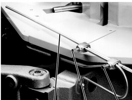
Das Blasrohr 5 am Drehtisch ist so lange aktiv, wie die Beschneidkopf eingeschaltet ist. Es soll alle abgeschnittenen Stoffreste am Drehtisch wegblasen.
