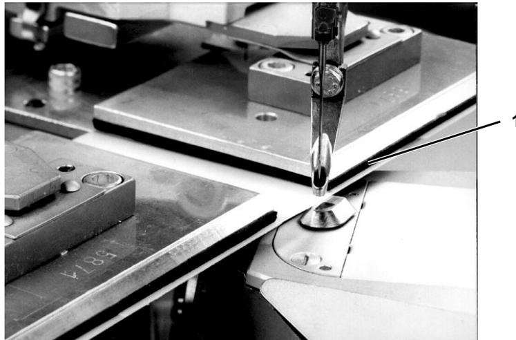
Das Gummi 1 an den oberen Klammerhälften soll das Nähgut so fixieren, daß es während des Nähvorganges nicht aus der Klammer herausgezogen werden kann.
