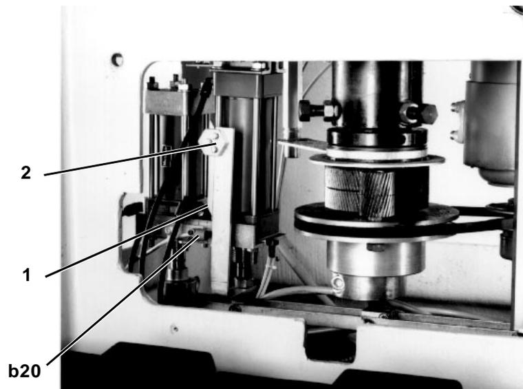
Die Schiene 1 betätigt den Schalter b20 während des automatischen Ablaufes und gibt den Impuls zum Auslösen des Staplervorganges. Der Schaltvorgang soll zu Beginn der Klammerlüftung erfolgen.
