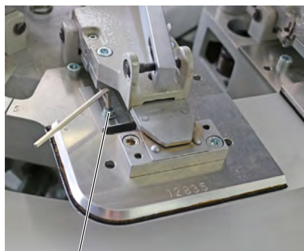
Fig. 20: Régler les butées de profondeur des porte-ouvrages ajustables
