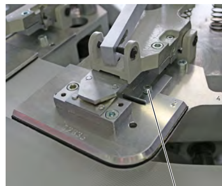
Fig. 20: Régler les butées de profondeur des porte-ouvrages ajustables
