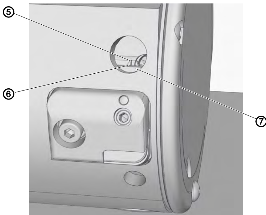
Obr. 60: Základní poloha odstříhu nitě a poloha pohyblivého nože odstříhu (2)
