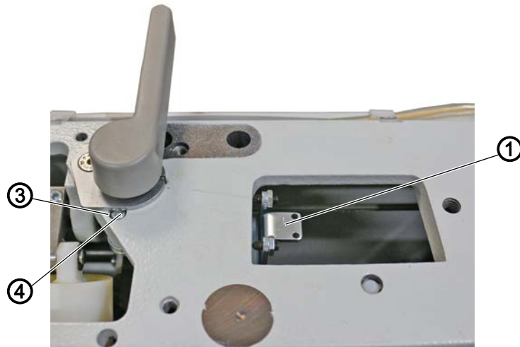
Abb. 9: Neue Spannungsplatte montieren
