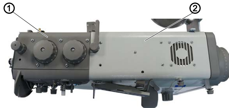
Abb. 4: Alte Spannungsplatte demontieren
