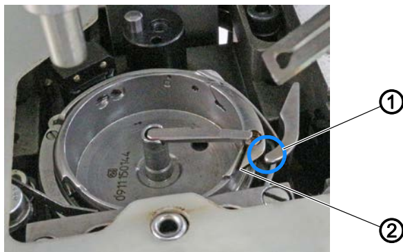
图 31: 设置抬升间隙 ( 安全带专用旋梭支架 ) (1)
