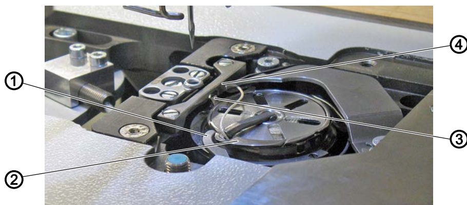
图 29: 设置梭芯套打开器
