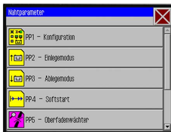
图 104: 更改线缝程序参数
