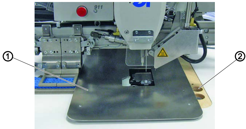
图 9: 取下和装入布料滑板
