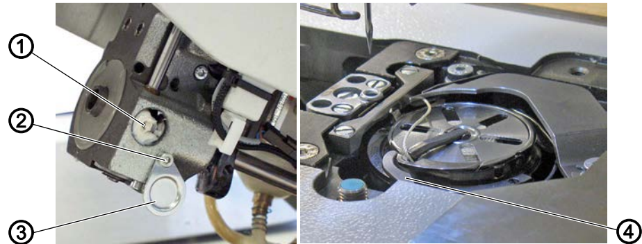
图 30: 设置抬升间隙 (标准旋梭支架)
