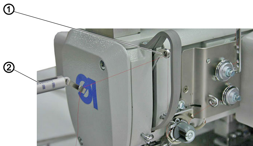
图 46: 校准夹线器板
