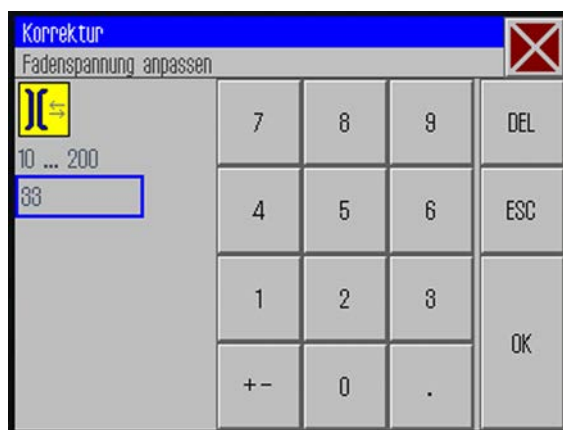
图 93: 使用更改后的缝线张力缝纫
