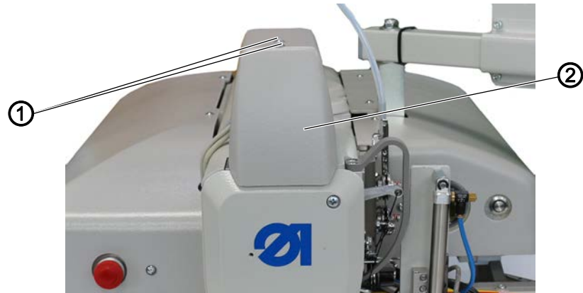
图 3: 取下和装上电机盖
