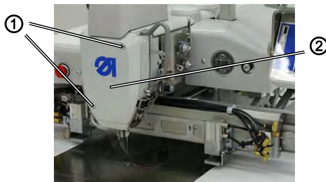
3. ábra: A homloklap levétele és felhelyezése
