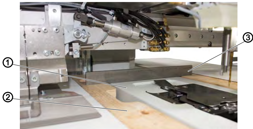
6. ábra: Gép felső rész beigazítása (1)
