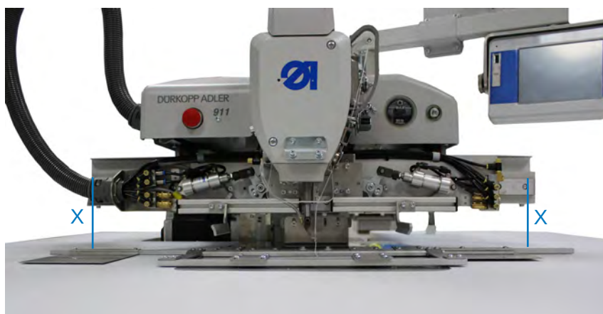
7. ábra: Gép felső rész beigazítása (2)
