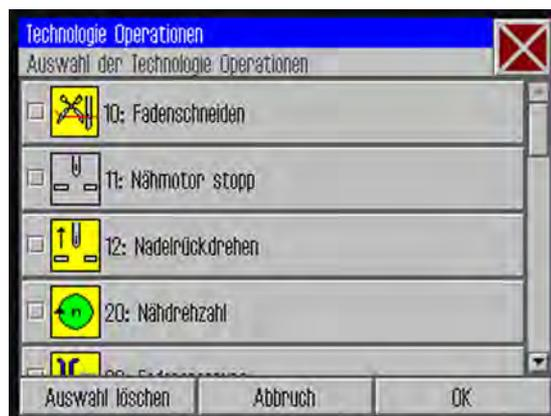
6. Gewünschte Technologie-Operation(en) für die neue Nahtstrecke auswählen (📖 S. 80).
