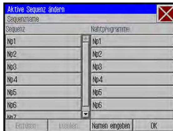
3. Programme über die Schaltflächen **Einfügen** und **Löschen** der Sequenz hinzufügen oder aus der Sequenz entfernen. Die Arbeitsweise entspricht dem Vorgehen beim Erstellen einer neuen Sequenz (📖 S. 95).
