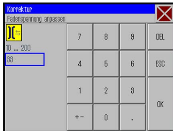
Fig. 32: Coudre avec une tension des fils modifiée
