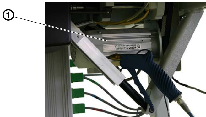
(1) - Filtre de ventilateur du moteur
