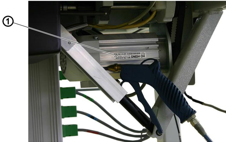
(1) - Filtro del ventilador del motor
