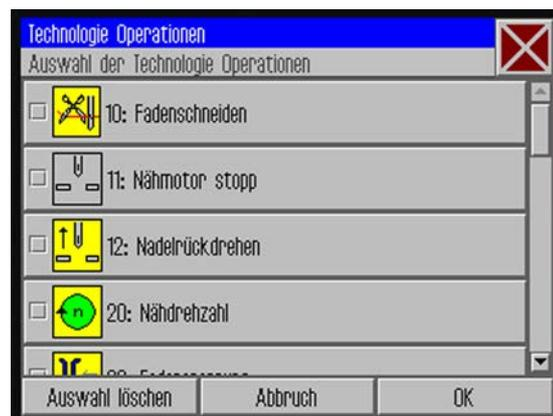
6. Gewünschte Technologie-Operation(en) für die neue Nahtstrecke auswählen (📖 S. 37).
