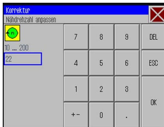
Obr. 33: Šití se změněnými otáčkami šití
