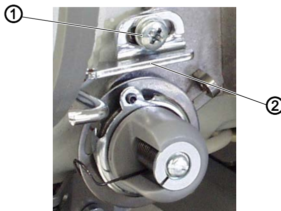
Obr. 11: Nastavení regulátoru tahové síly niti
