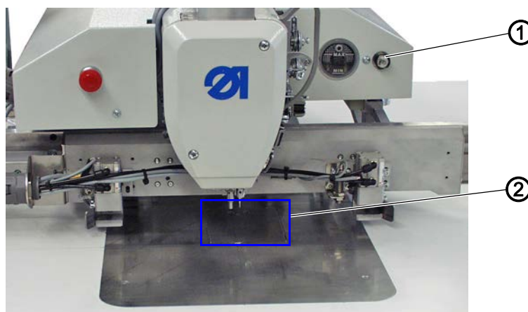
Obr. 3: Zapnutí bezpečného zastavení
