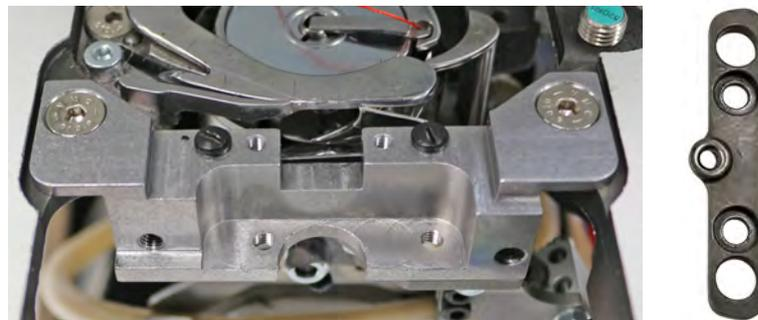
Prüfen Sie, ob der korrekte Stichplattenhalter (Teilenummer 0911 207514) mit der korrekten Stichplatte montiert ist.
