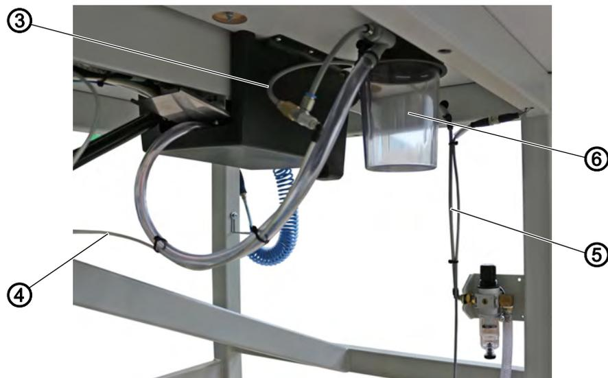
(3) - Pneumatikschlauch
