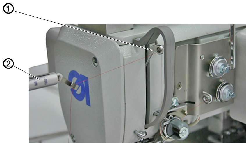
Rys. 40: Kalibracja elektronicznej płytki naprężenia nitki
