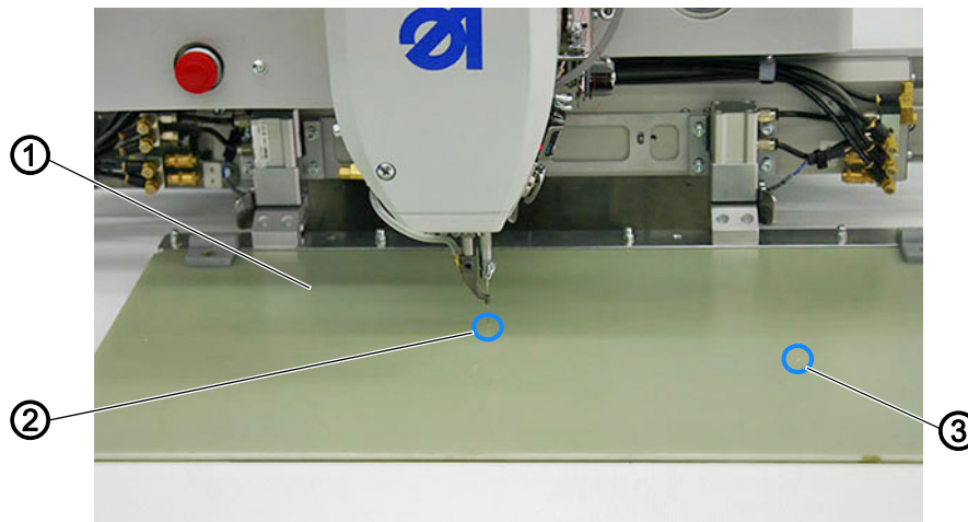
Rys. 62: Sprawdzenie punktu zerowego maszyny
