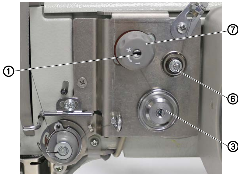
Rys. 43: Kalibracja mechaniczno-elektronicznej płytki naprężacza nitki
