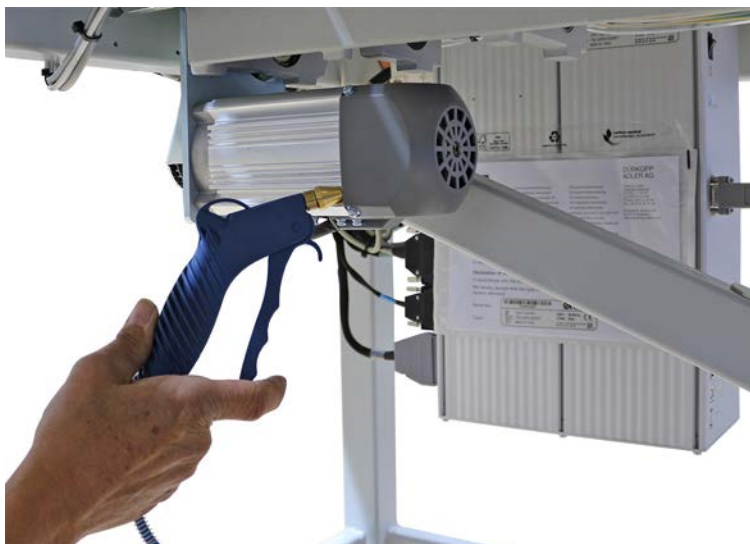
Rys. 113: Czyszczenie sitka wentylatora silnika
