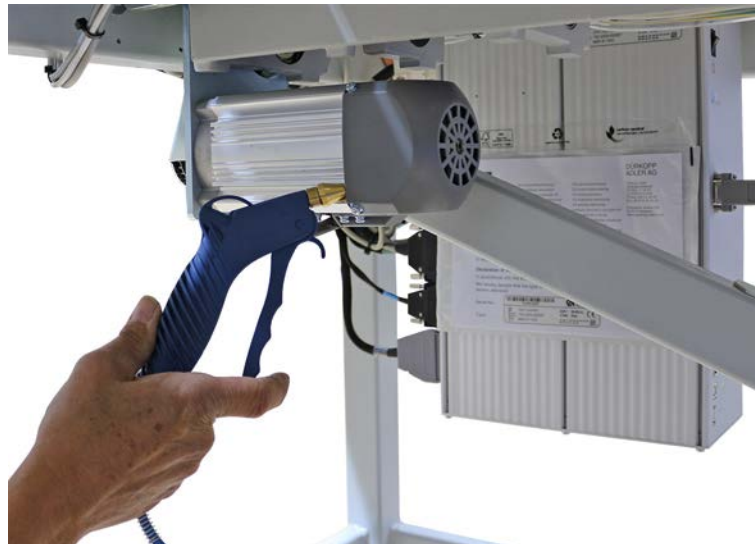
Fig. 113: Cleaning the motor fan mesh
