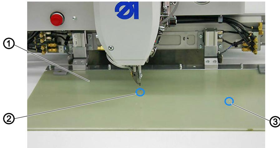
(1) - Klammer mit Prüfungsbohrungen      (3) - Testbohrung
