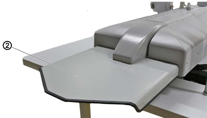
图 70: 安装后部机器盖板 (3)
