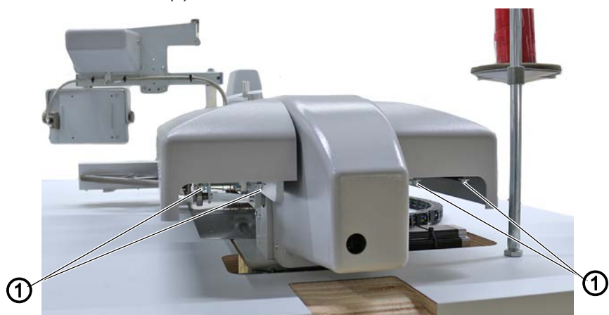
图 68: 安装后部机器盖板 (1)
