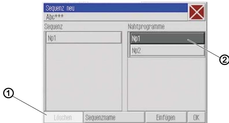
(1) - Ausgegraut: Deaktiviertes Element (2) - Dunkel hinterlegt: Aktiviertes Element
