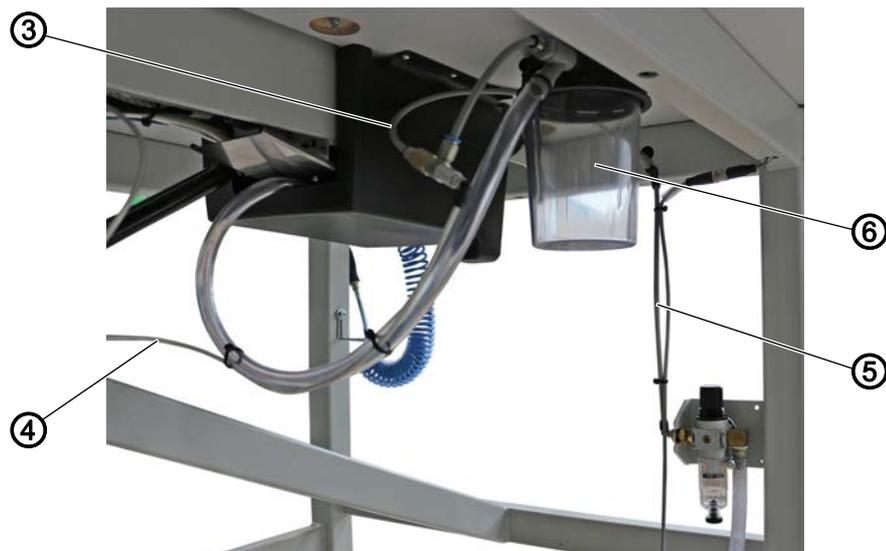
(3) - Pneumatikschlauch
