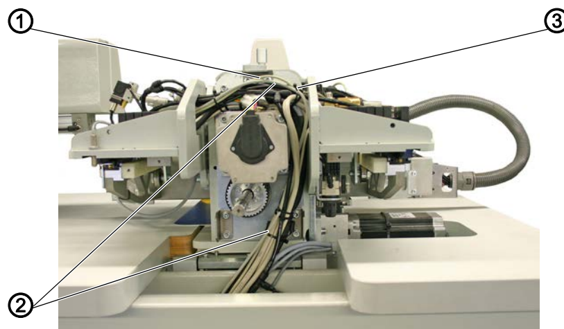
Abb. 7: Zuleitungen verlegen, Rückansicht
