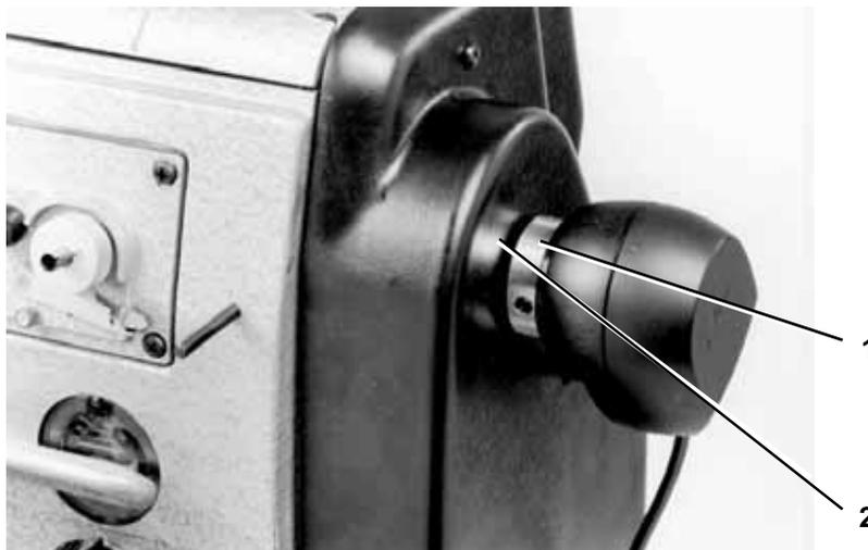
Vérifier avant le réglage si le transmetteur de position est fixé correctement.
