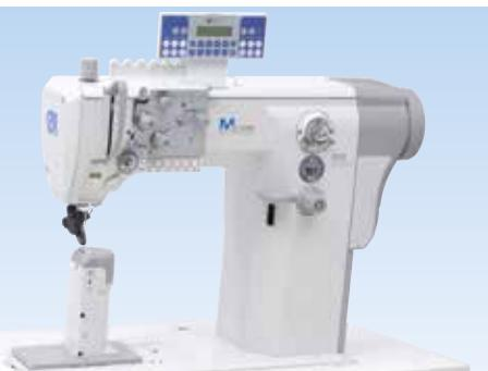
**M-TYPE 888-160122-M:** Máquina de columna de doble pespunte y una sola aguja, con rueda de arrastre, transporte de aguja y prensatelas accionado por rodillo. Opcionalmente, la máquina se puede equipar con un juego de piezas 0888 600214 para realizar costura francesa, o un conjunto de piezas para fijar cintas de refuerzo.
