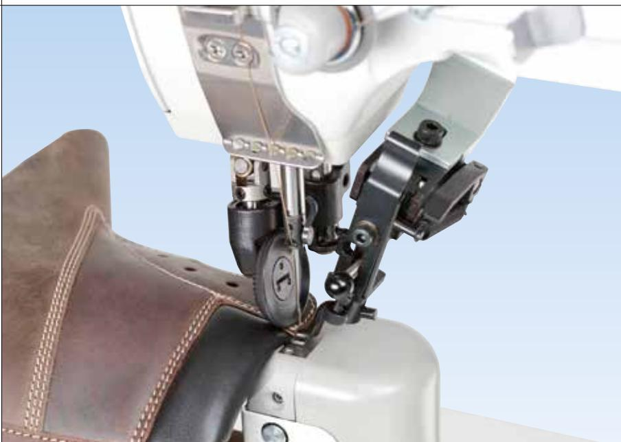
**888 Una sola aguja:** Unión de piezas, costura elegante, armado, inserción de cremalleras, pespunte de la parte superior – las máquinas son flexibles para realizar todas las operaciones de costura que se hacen en las máquinas de una sola aguja.
