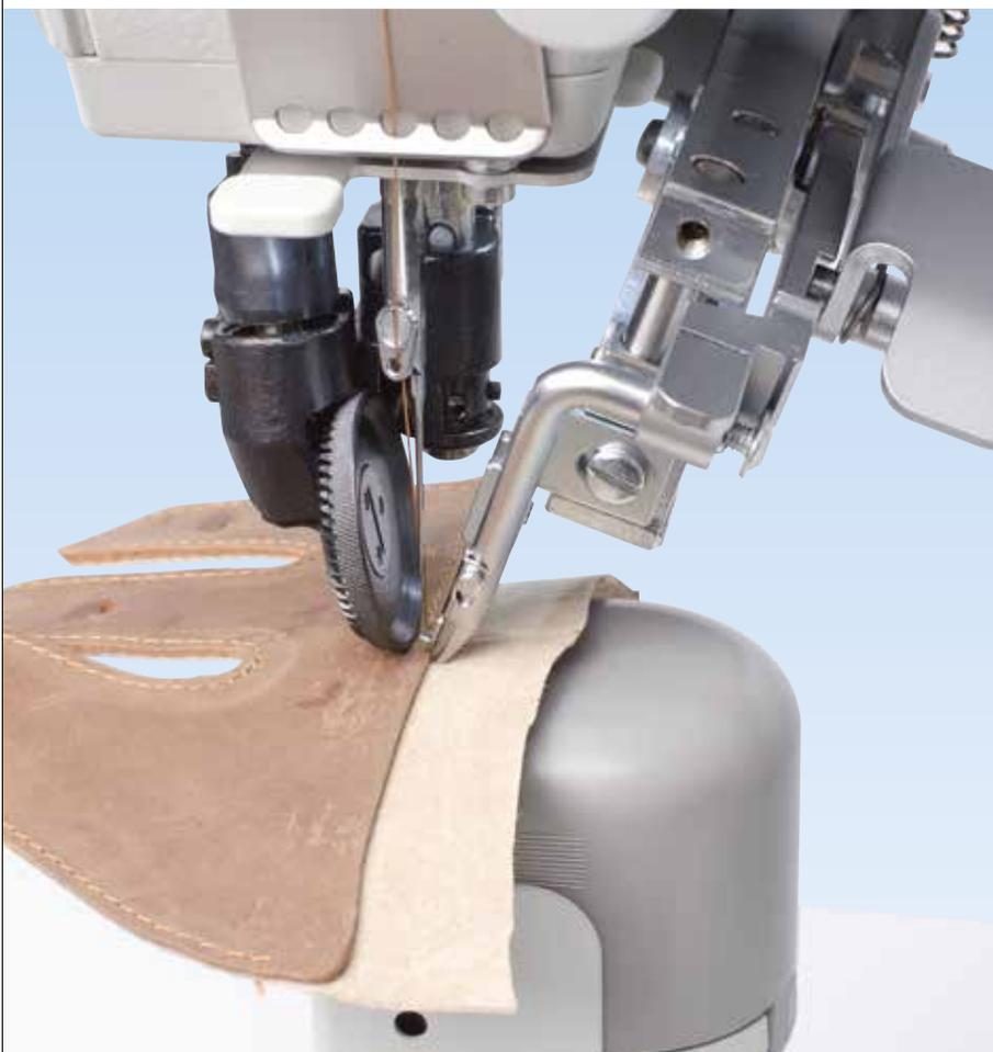
Futter einnähen mit gleichzeitigem schrägem Beschneiden von oben
