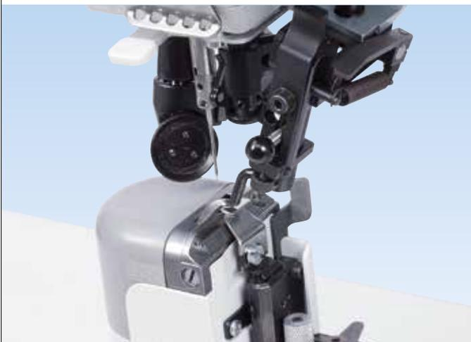
**M-TYPE 888-356122-M:** Detail der Unterschneideeinrichtung
