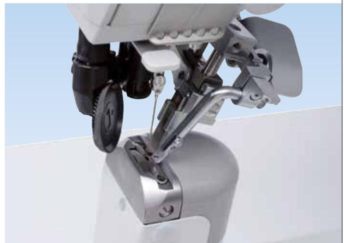
**M-TYPE 888-167122-M:** Detail des Schrägschneiders
