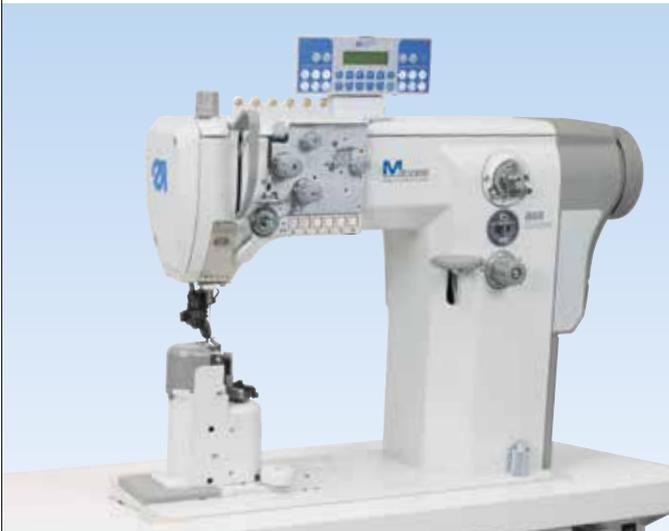
**M-TYPE 888-356122-M:** Einnadel Doppelsteppstich Säulenmaschine mit integriertem Direktantrieb, Schiebrad- und Nadeltransport, angetriebenem Rollfuß, elektromagnetischem Fadenabschneider, automatischer Nahtverriegelung und Rollfußlüftung. Linke Säule mit elektromotorisch angetriebener Futter Beschneideeinrichtung von unten.
