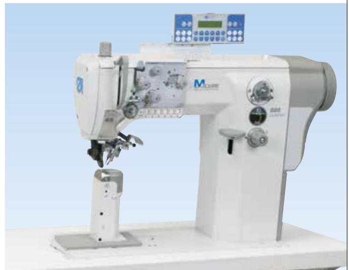
**M-TYPE 888-167122-M:** Einnadel Doppelsteppstich Säulenmaschine mit integriertem Direktantrieb, Schiebrad- und Nadeltransport, angetriebenem Rollfuß, elektromagnetischem Fadenabschneider, automatischer Nahtverriegelung und Rollfußlüftung. Rechte Säule mit elektromotorisch angetriebener Futter Beschneideeinrichtung schräg von oben.
