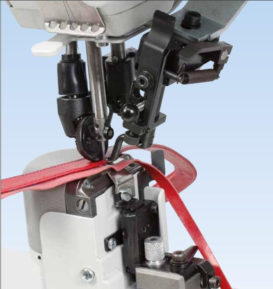
Futter einnähen mit gleichzeitigem Beschneiden von unten
