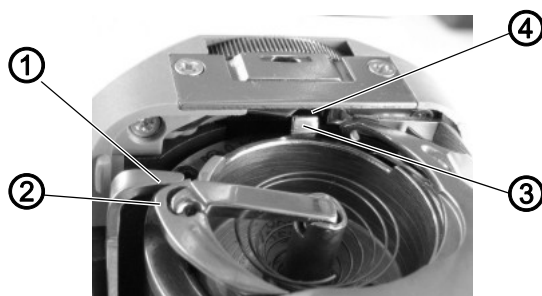
Rys. 29: Ustawianie otwarcia środkowej części chwytacza
