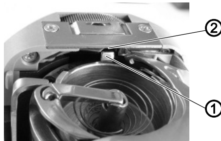
Rys. 30: Ustawianie odstępu podnoszenia (1)
