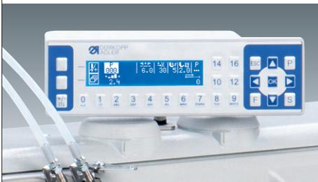
**Programmsteuerung mit Standard-Bedienfeld OP3000** – Neben der manuellen Eingabe aller relevanten Nähparameter für einen Nähprozess können im Automatikmodus zuvor programmierte Setups oder komplexe Nahtprogramme aufgerufen werden.
