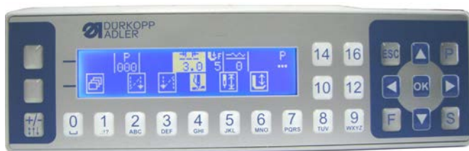
Abb. 42: Bedienfeld der Steuerung
