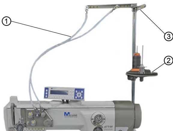
Abb. 8: Greiferfaden aufspulen – Teil 1
