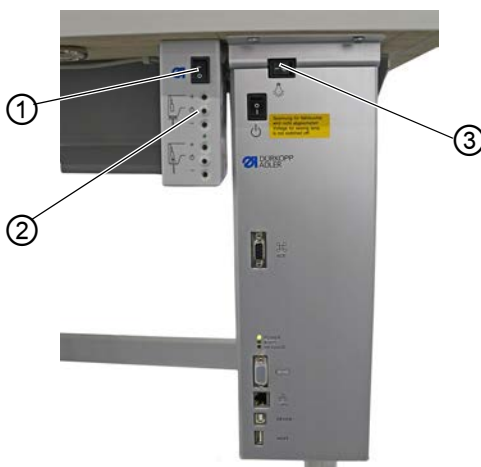
Obr. 3: Zapnutí a vypnutí stroje
