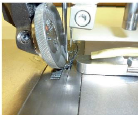
Stanzmesser an einer Flachbett/ Radtransport/Nähmaschine
