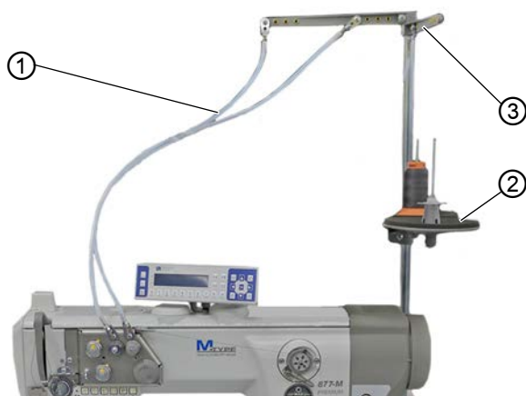
Obr. 8: Navinutí spodní nitě - část 1
