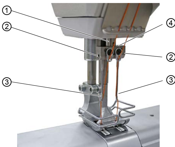
Image 5: Mettre en place ou changer l'aiguille (2)
