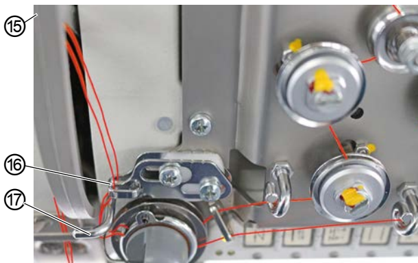
Image 13: Enfiler le fil d'aiguille (machine à 2 aiguilles) (4)
