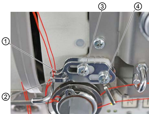
Image 24: Régler le régulateur de fil d'aiguille (2)
