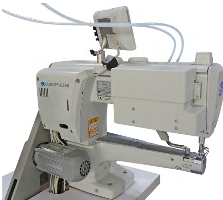
Abb. 12: Zweiachsigen elektronischen Kantenanschlag montieren (6)
