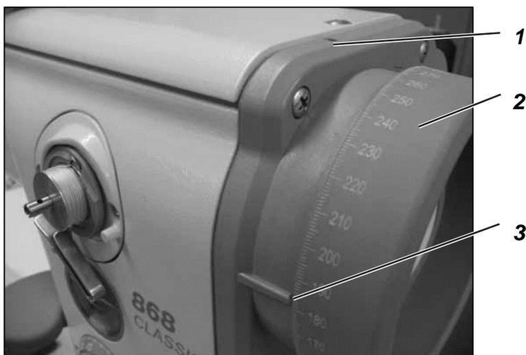
El volante **2** tiene impresa una escala de grados.
