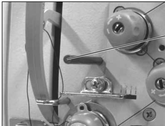
El pasador de bloqueo necesario para ajustar la máquina **1** está incluido de serie con la máquina. Está incluido en el paquete adjunto de la máquina y puede fijarse en el lado inferior del cárter, de forma que tenga un fácil acceso.
