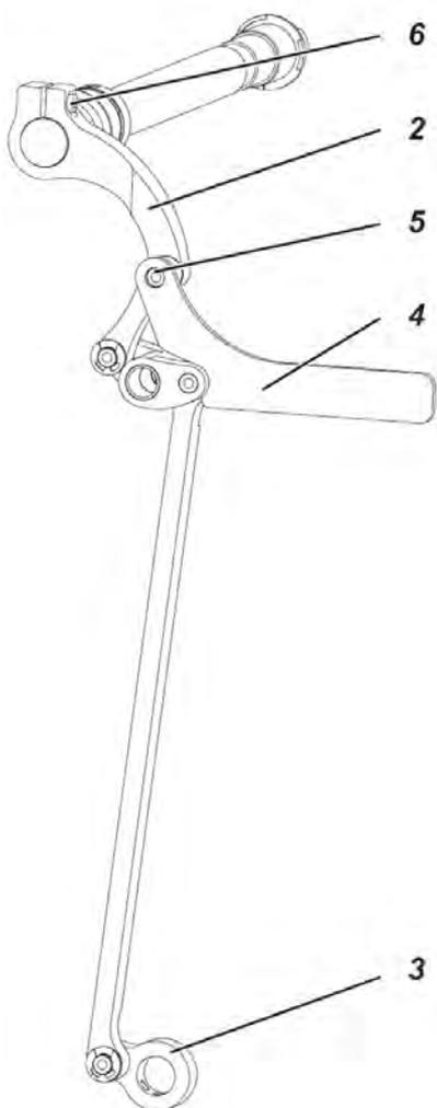
La palanca **3** transmite el movimiento del eje de avance a la corredera de la barra de la aguja.
