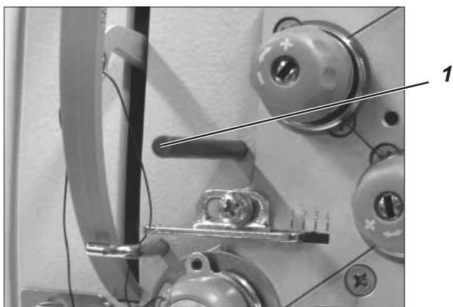
Der zum Einstellen der Maschine benötigte Arretierstift 1 liegt der Maschine serienmäßig bei. Er befindet sich im Beipack der Maschine und kann gut zugänglich an der Unterseite der Ölwanne befestigt werden.
