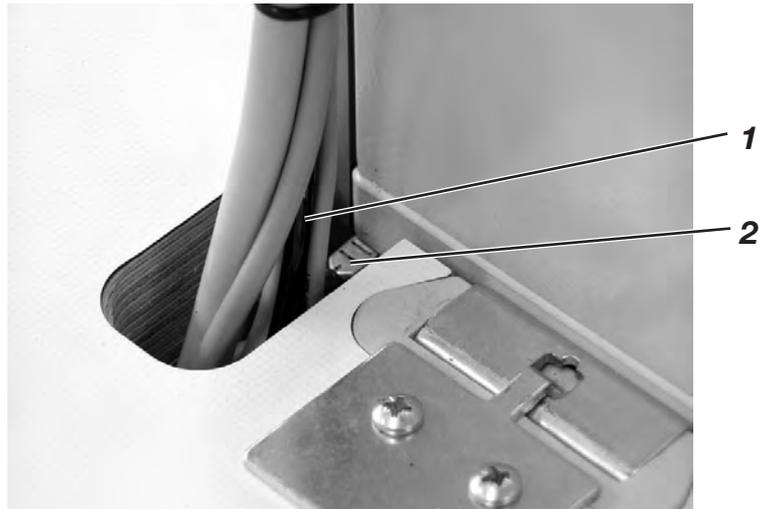
Die Erdungsleitung 1 befindet sich im Beipack der Maschine.
