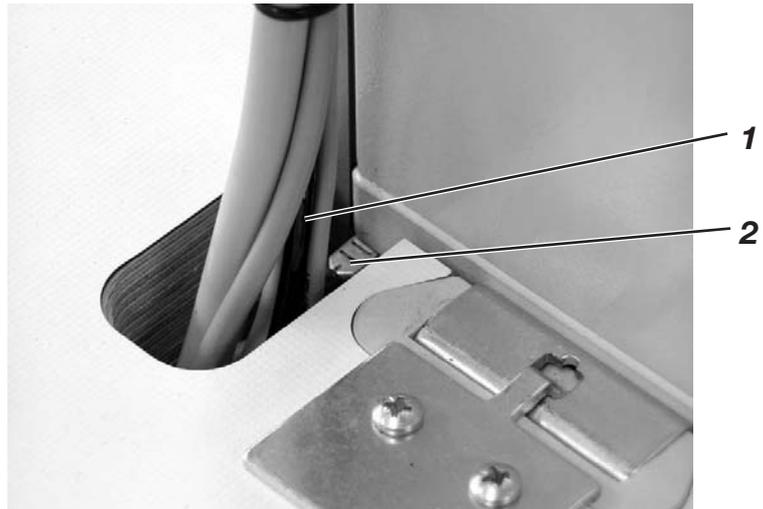
Il conduttore di terra 1 si trova nel kit di accessori della macchina.
