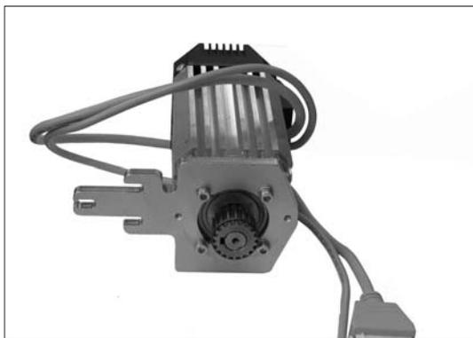
Posizione del supporto motore per il montaggio inclinato della testa.
