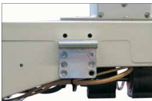
Position der Scharniere für die schräge Aufstellung des Oberteils.
