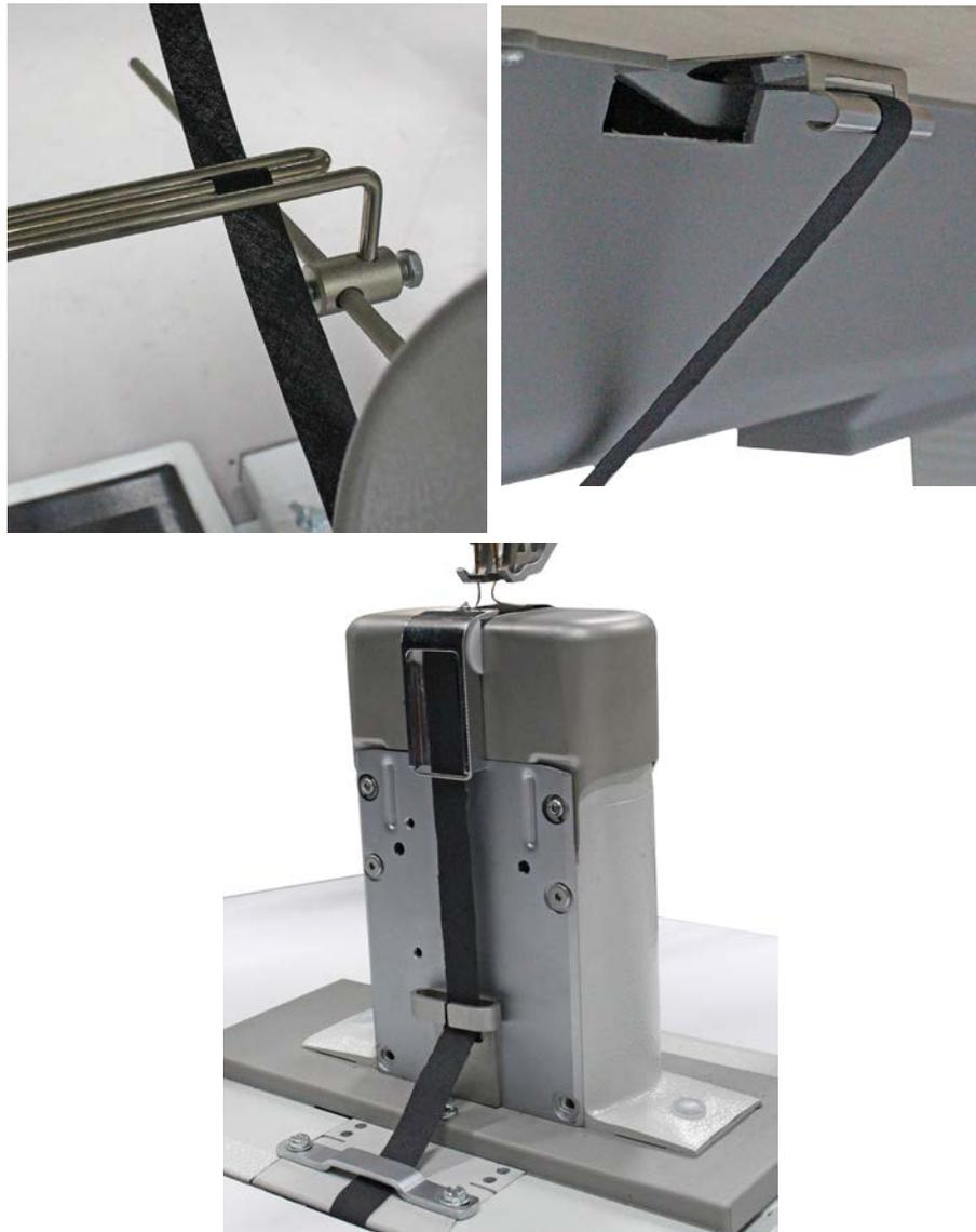
10. Band einfädeln, wie abgebildet. Das Band muss ohne Verdrehungen bis zur Nadel laufen.
