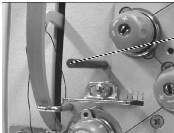
O pino de bloqueio 1 necessário para o ajuste da máquina é fornecido de série com a máquina. Encontra-se na embalagem da máquina e pode ser fixado na parte inferior do cárter do óleo, de fácil acesso.
