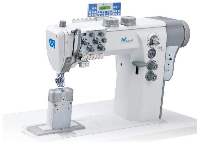
**M-TYPE 868-490322-M CLASSIC:** Die Zweiadel-Doppelsteppstich-Säulenmaschine mit schaltbaren Nadelstangen – der einzigartige Nadelstangenantrieb unterstützt die vielfältigen Einsatzmöglichkeiten im Ziernahtbereich.
