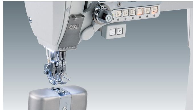
**M-TYPE 868-490322-M:** Ergonomisches M-TYPE Design – die grifffündig angeordnete Tasterleiste ermöglicht das einfache Deaktivieren bzw. Aktivieren der jeweiligen Nadelstange während des Nähprozesses.
