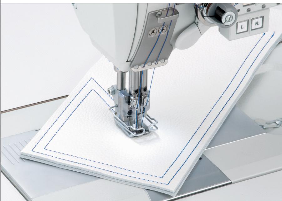
Die speziellen M-TYPE Unterklassen mit schaltbaren Nadelstangen sind ideale Betriebsmittel für Zweiadel Zierstichapplikationen. Neben hochwertigen Zweiadel-Aussteppnähten können auf Grund der schaltbaren Nadelstangen zusätzlich optisch ansprechende Zierstichecken erzeugt werden.
