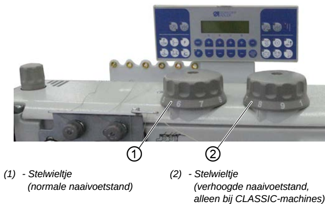
Afb. 37: Hoogte van de naaivoetstand instellen
