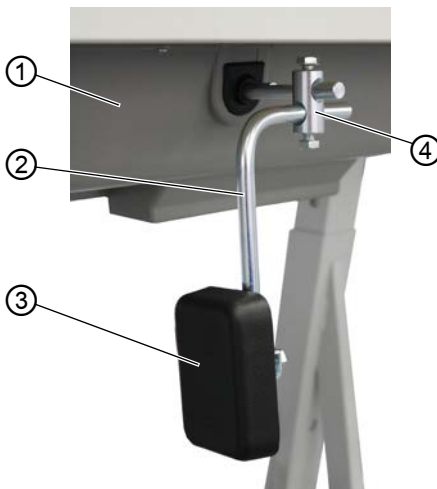
Afb. 89: Mechanische kniehendel monteren (1)
