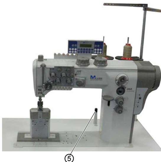
Afb. 85: Bovenste deel van de machine plaatsen (5)
