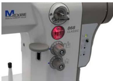
Image 66: Vérifier le niveau d'huile (2)
