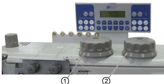
Image 37: Régler la course de levage
