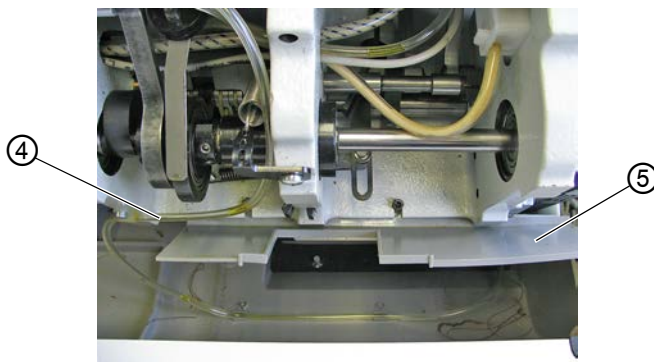
Image 93: Monter le conduit d'aspiration d'huile (2)
