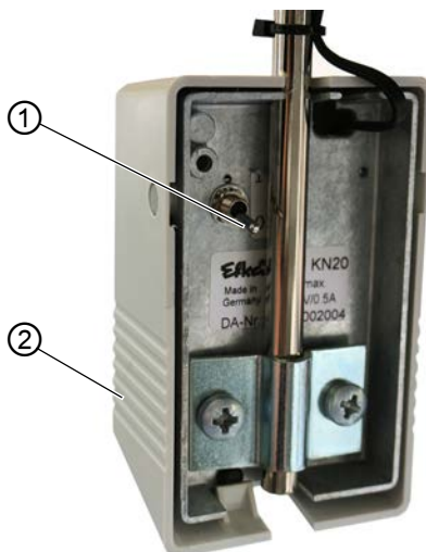
(1) - Interrupteur à bascule
