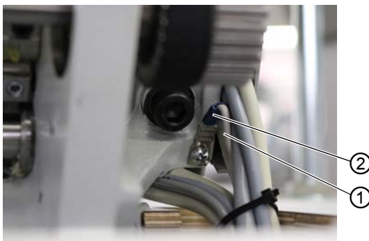
Image 94: Établir la liaison équipotentielle
