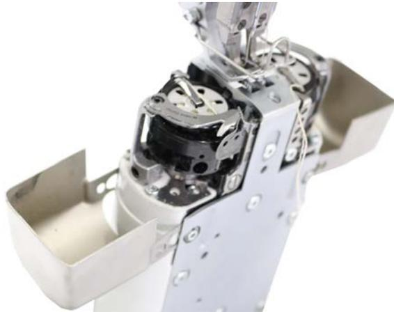
Der linke Greifer ist genauso aufgebaut wie der rechte Greifer, nur um 180° gedreht.
