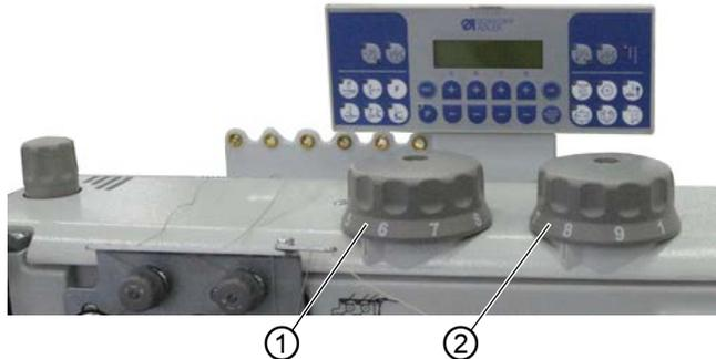
(1) - Stellrad (normaler Nähfuß-Hub) (2) - Stellrad (erhöhter Nähfuß-Hub, nur bei CLASSIC-Maschinen)
