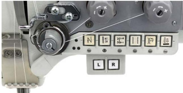
Die Maschine hat einen Tastenblock am Maschinenarm, mit dem bestimmte Funktionen während des Nähens aktiviert werden können.
