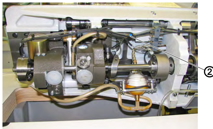
Abb. 9: Y-Stück bei 2 Lichtschranken
