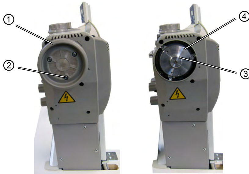
Abb. 2: Handrad und Handradflansch abbauen
