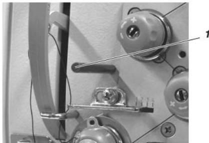
Необходимый для регулировки машины стопорный штифт 1 прилагается к машине в зависимости от серии. Он находится среди комплектующих, для быстрого доступа его можно прикрепить к нижней стороне масляной ванночки.
