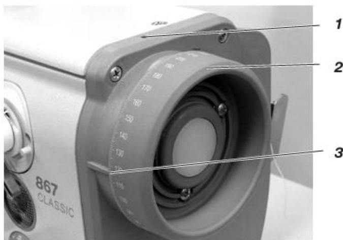
На маховике нанесены значения градуса. Определенные регулировки осуществляются при помощи маховика. Провернуть маховик настолько, чтобы указанное в данной инструкции число градусов стояло на стрелке 3.
