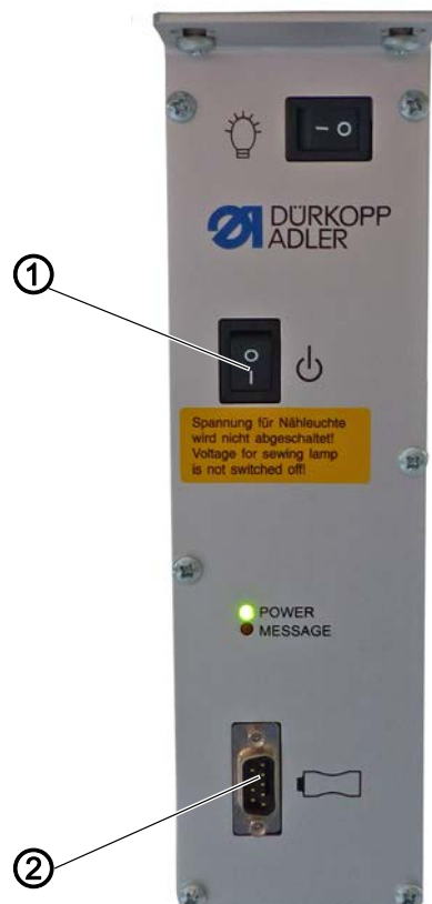
Abb. 3: Softwareupdate der Steuerung durchführen
